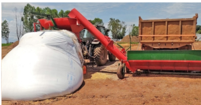
DESCARGA DIRETA DO CAMINHÃO
