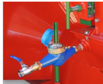
MEDIDOR DE VAZÃO DE ÁGUA
